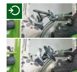
■ Para lograr una postura óptima en el asiento, el volante debe encontrarse a la altura y en el ángulo de inclinación adecuados. El volante, incluyendo el salpicadero, es ajustable de forma individual.
