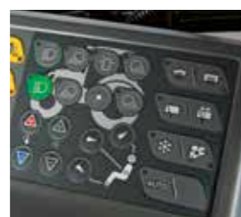
■ El aire acondicionado integrado garantiza una refrigeración óptima y una gran comodidad: con control manual en la versión Power y con control totalmente automático en el Fendt 300 Vario Profi.
