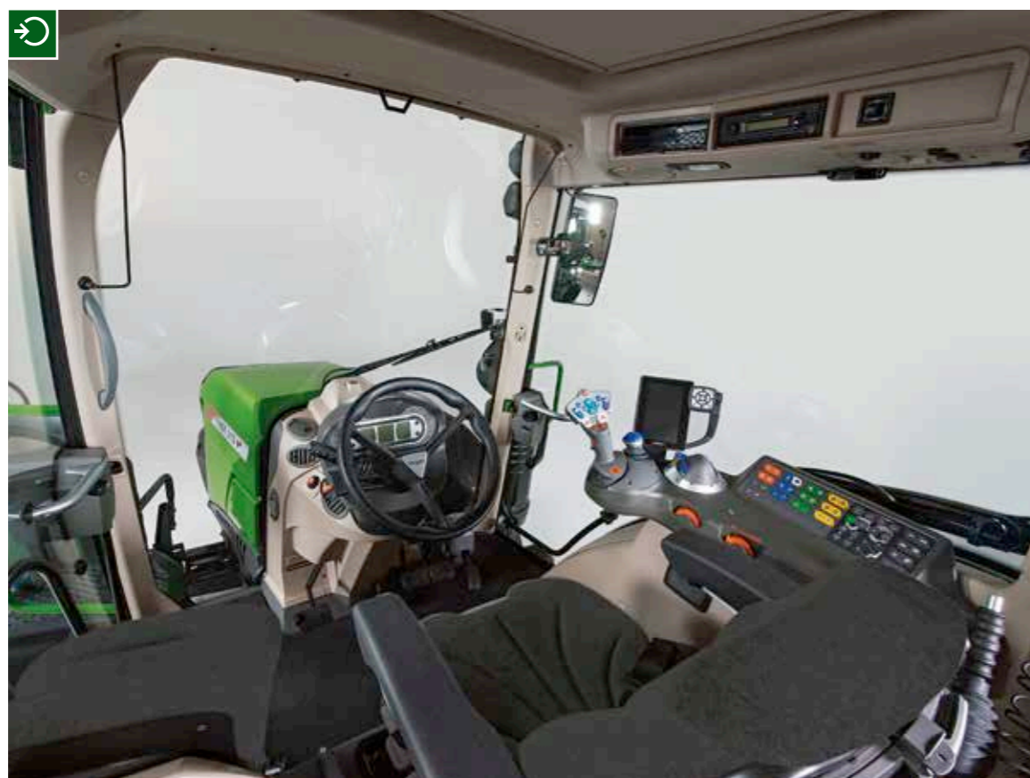
La cabina VisioPlus, con una distribución clara y un diseño ergonómico, ofrece la máxima visibilidad tanto de los elementos de mando como del campo. El parabrisas está disponible en forma de luneta panorámica continua o luneta abatible. Puede elegirse una puerta adicional en el lado derecho de la cabina.
