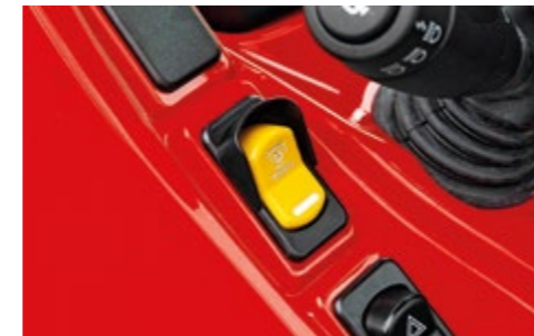
MANDO DE FUNCIONAMIENTO CONTINUO DE LA TOMA DE FUERZA Mantiene activada la TDF aunque el conductor no esté en su puesto.
